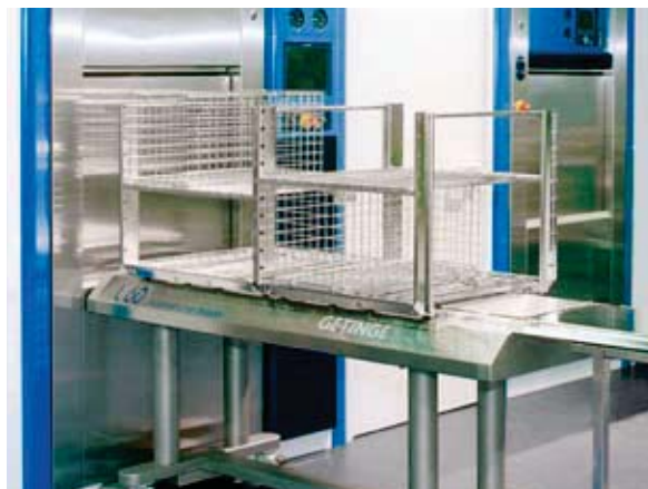
Automatyczny załadunek regału wsadowego. System ten może być stosowany dla platform załadownych. Stosowany jest w połączeniu z wózkiem transportowym załadunku sterylizatora.
